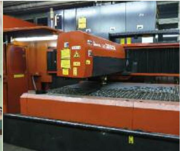
Stahlbearbeitung mit der Laseranlage.
