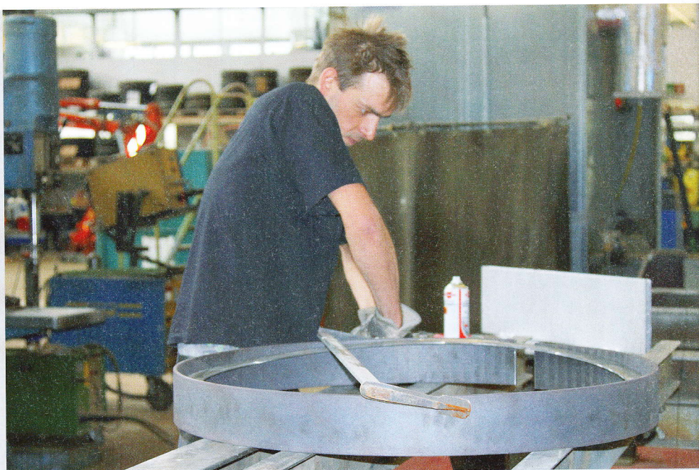
Ausgeschriebene Bauteile, aber auch eigenes Design werden von der FMH gefertigt. Hier entsteht eine Blechform aus Stahl für ein Pflanzenbeet.
